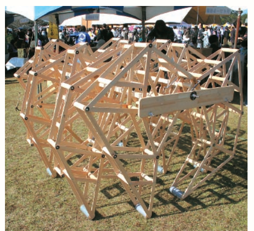
▲ハードウェア(株)が製作した風で動くロボット
